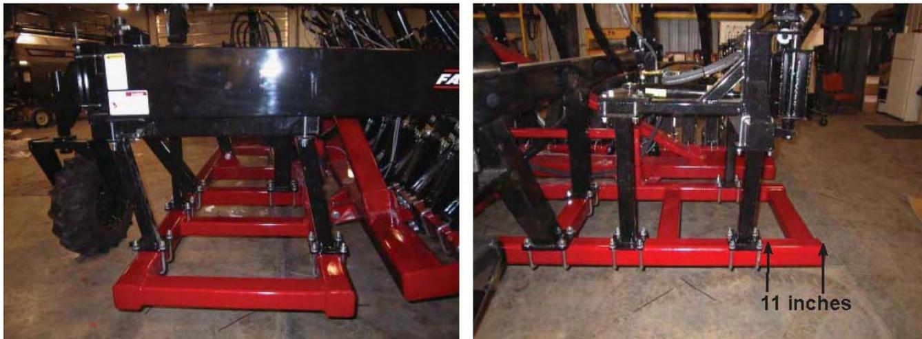
Установите прямую опору внутри продольного компонента рамы. Закрепите п-образными болтами 5/8 дюйма, но не затягивайте.
