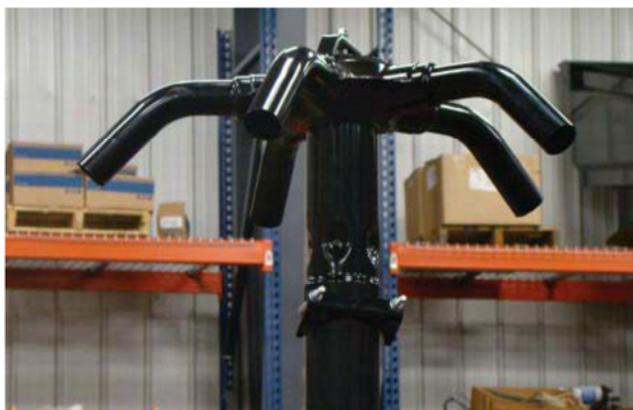
Выпускные отверстия должны быть расположены так, как показано на схеме. Шланги предварительно обрезаны так, чтобы соединяться с коллекторами вторичного контура. Используйте 2 самых длинных шланга на внешних коллекторах и остальные шланги – на других коллекторах.
