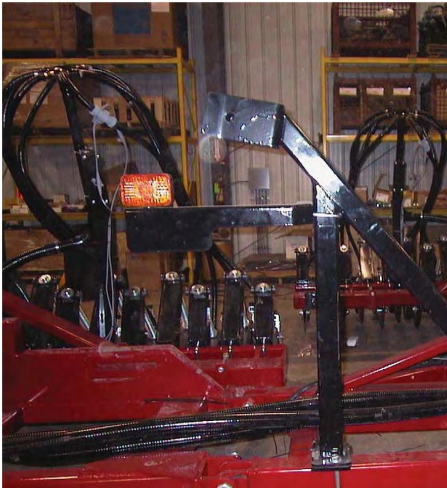
**Примечание: Не забудьте затянуть гайки на стойках упора крыльев.**
