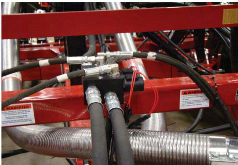
Подсоедините гидравлические шланги ¾ дюйма к передним и задним портам клапана. Шланг, подсоединяемый к порту «Р», должен быть подключен к перепускному клапану бункера высевающего аппарата
