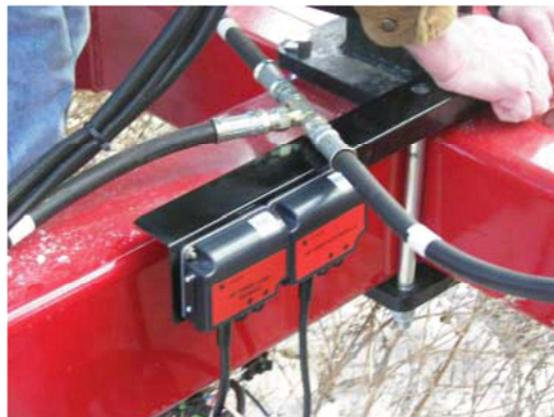
Подсоедините самый длинный черный кабель блока (5-метровый) к разъему переднего блока и протяните к передней стороне сеялки. Подсоедините 3-метровый кабель к разъему заднего блока и протяните к сцепке в задней части сеялки.
