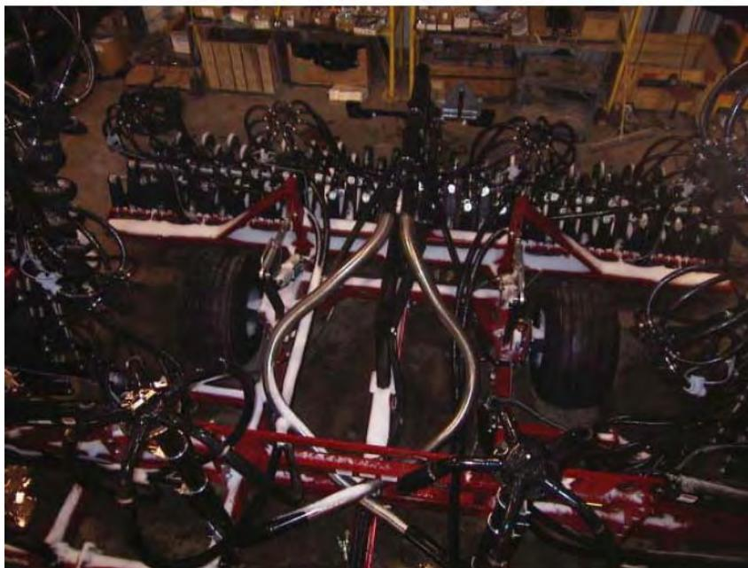
Стойки коллекторов первичного контура должны быть установлены почти на одном уровне, с небольшой разницей, которая позволит расположить 4-дюймовые шланги внахлест.
