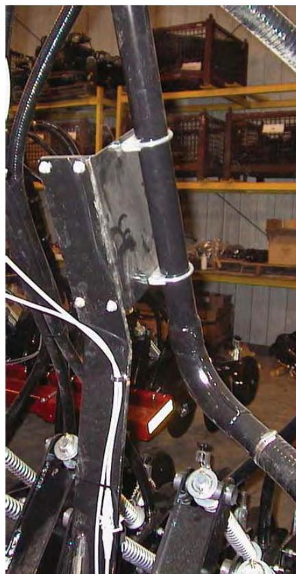
Подсоедините 1,25-дюймовые шланги между выпускными отверстиями коллекторов и дисковыми открывающими сошниками. Зафиксируйте шланги хомутами. Обрежьте все 1,25-дюймовые шланги до длины 75 дюймов (191 мм).
